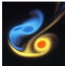
image utilisée : détail du champ de vorticité dans une simulation numérique de tourbillons dans un sillage bidimensionnel lointain [d'après un cliché Y. Fouillet (Grenoble), extrait de "La Turbulence" de Marcel Lesieur aux Presses Universitaires de Grenoble]
